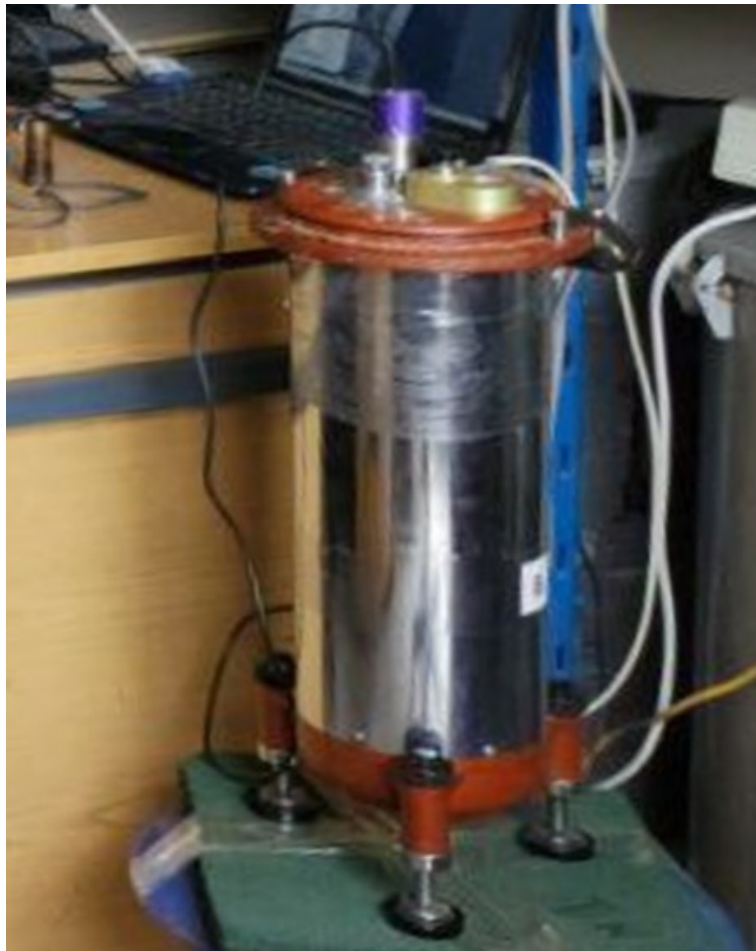
Рисунок 18. Гравиметр ГНУ-КВ с установленной камерой (цифровым окуляром)
