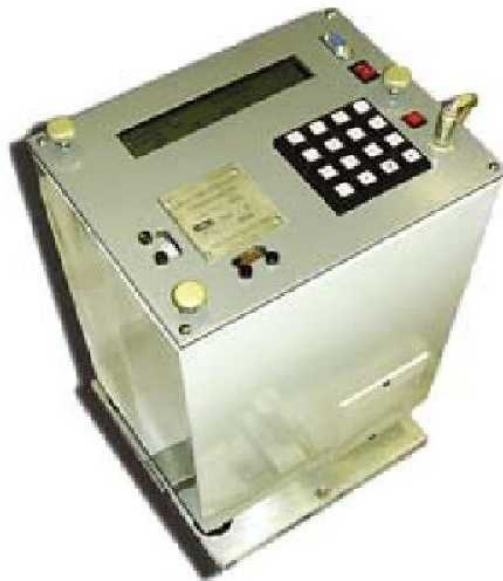
Рисунок 14. Гравиметр наземный с кварцевой чувствительной системой и компьютерным управлением ГНУ-КВК
